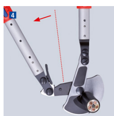
Efter första delsnitt öppnas skänklarna genom spärrmekanism
