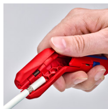
Avmantling av koaxialkabel
