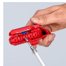
Avisolering av koaxialkabel
